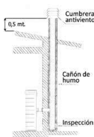
Fig. 2: conexión con el cañón de humo
