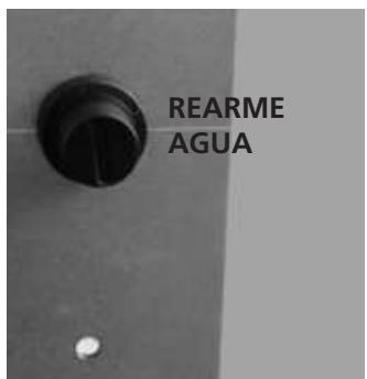
**Sonda de temperatura de bulbo en el depósito del agua:** si la temperatura supera el valor de seguridad programado, detiene inmediatamente el funcionamiento de la Termoestufa y en la pantalla se "**ALAR-SIC-FAIL**". Para volver a ponerla en marcha es necesario restablecer la sonda manualmente.
