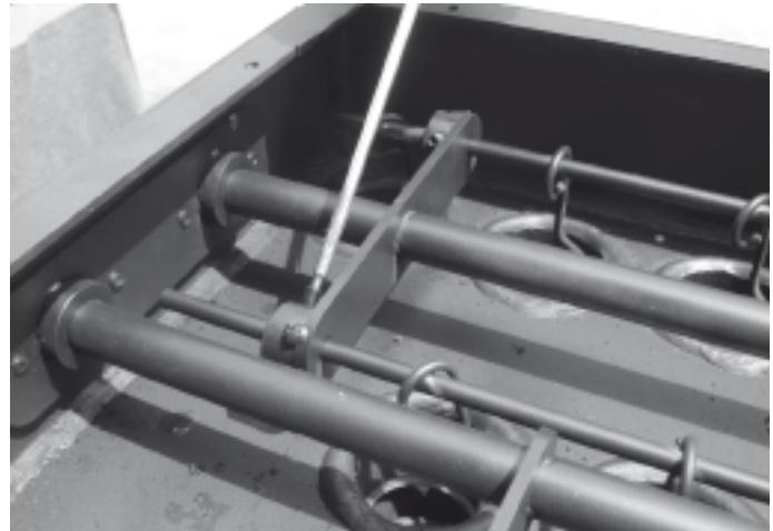
La operación se puede completar con un destornillador destornillar la pared de la Salamandra hidro y la eliminación de todas las juntas horizontales.
