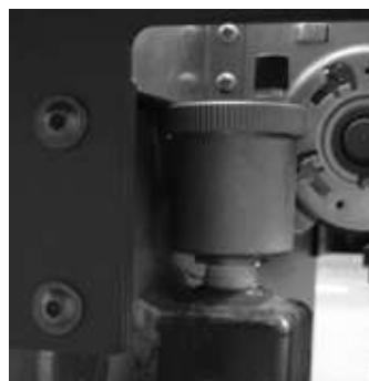
**Válvula de ventilación automática:** esta válvula elimina el aire dentro de la Termoestufa y de la calefacción
