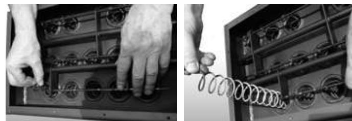
Pour faciliter le processus, la jonction peut faire défiler horizontalement et tirez grâce à un trou dans la paroi du corps de l'hydropoêle.
