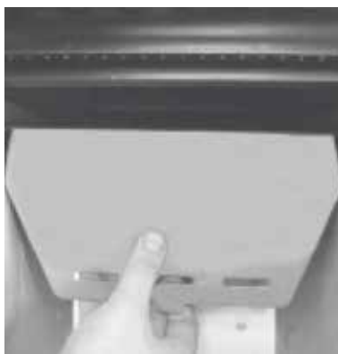
Fig. 16: tourner la plaque coupe-flamme
