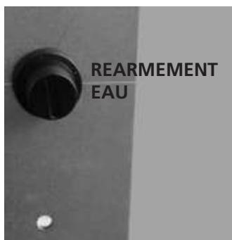
**Thermostat de sécurité à réarmement manuel pour la température de l'eau:** si la température de l'eau dépasse le niveau de sécurité programmée à 100° C arrête immédiatement le fonctionnement de l'appareil et l'écran affiche "ALAR-SIC-FAIL". Pour redémarrer, vous devez réinitialiser le thermostat manuellement.
