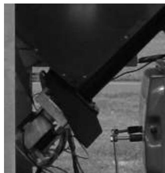
**Motorreductor:** si el motorreductor se detiene para la señal "**ALAR-DEP-FAIL**" o "**ALAR-SIC-FAIL**", la caldera sigue funcionando hasta que no se apaga la llama por falta de combustible y hasta alcanzar el nivel mínimo de enfriamiento.
