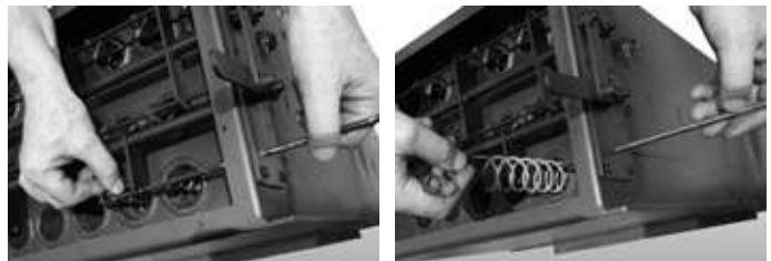
Maintenant la partie supérieure de l'échangeur de chaleur est libre de toute charge, afin de permettre le nettoyage parfait. Une fois par an est également recommandé de nettoyer le compartiment supérieur de l'échangeur.
