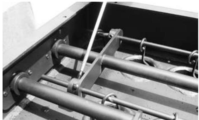
La operación se puede completar con un destornillador destornillar la pared de la Caldera y la eliminación de todas las juntas horizontales.
