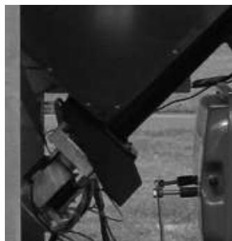
**Motoréducteur:** si le motoréducteur s'arrête, la Chaudière continue à fonctionner jusqu'à ce que la flamme sort par manque de carburant et jusqu'à ce qu'il atteigne le niveau minimum de refroidissement.
