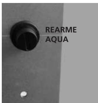
**Sonda de temperatura de bulbo en el depósito del agua:** si la temperatura supera el valor de seguridad programado, detiene inmediatamente el funcionamiento de la caldera y en la pantalla se "**ALAR-SIC-FAIL**". Para volver a ponerla en marcha es necesario restablecer la sonda manualmente
