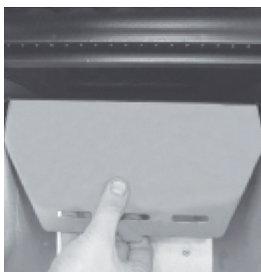
Fig. 16: tourner la plaque coupe-flamme
