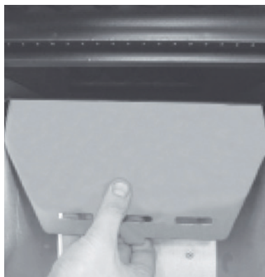
Abb. 16: Rotation der Feuerschutzwand
