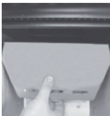
Εικ. 16: περιστροφή του διαχωριστικού φλόγας
