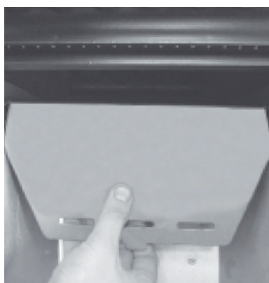
Fig. 16: rotação do defletor de chama
