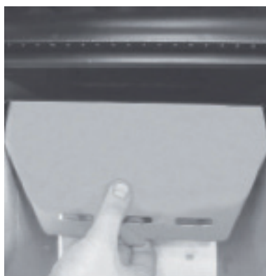
Εικ. 16: περιστροφή του διαχωριστικού φλόγας
