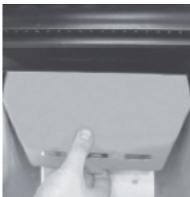
Fig. 16: tourner la plaque coupe-flamme
